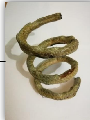
Arc elicoidal din SrPET/CPET
