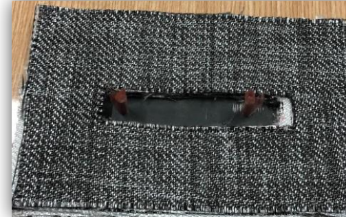
Poziționarea insertiei metalice
