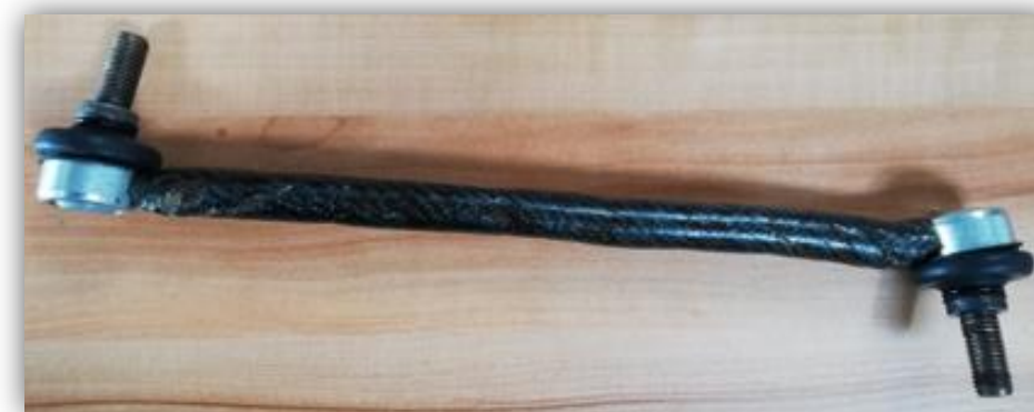
Prototip hibrid pentru o bieleta anti-ruliu
